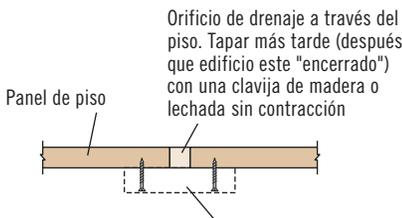
Placa de soporte de panel estructural de madera; atornillar-pegar en la parte inferior del piso antes de tapar el agujero para apoyar la reparación con una clavija de madera o lechada
